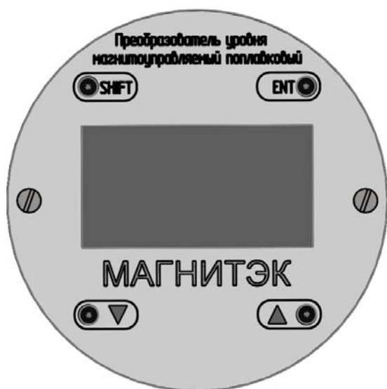
Рисунок 10 – Схематичное изображение местного индикатора и назначение кнопок управления
