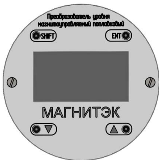
Рисунок 6 – Схематичное изображение местного индикатора в режиме «Отображение измеренных значений» и назначение кнопок управления
