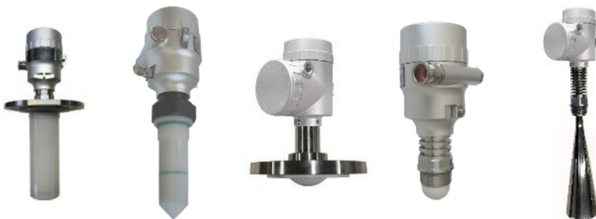
Рисунок 3 – Общий вид преобразователей с антеннами разных исполнений (слева направо: цилиндрическая узконаправленная, цилиндрическая широконаправленная, линзовая узконаправленная, линзовая, рупорная).
