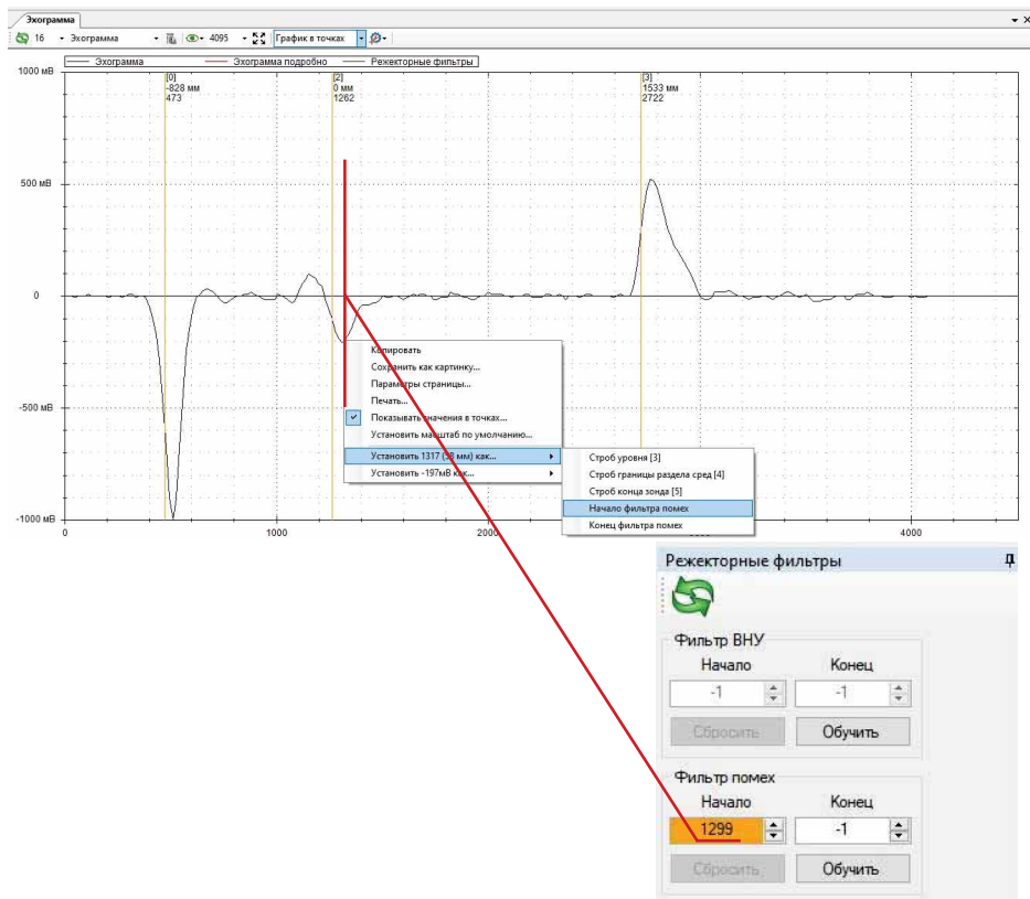
Рисунок 32. Установка начала фильтра помех
